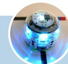
Der Ozobot kann durch das Zeichnen von Linien und den Gebrauch von Farbcodes programmiert werden. Darüber hinaus ist es möglich per App eine Blockprogrammierung in verschiedenen Schwierigkeitsstufen zu erstellen.
