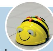
Der Bienenroboter ermöglicht Kindern von 4 bis 7 Jahren über das Bedienen von Pfeiltasten eine Einführung in die Logik des Programmierens.
